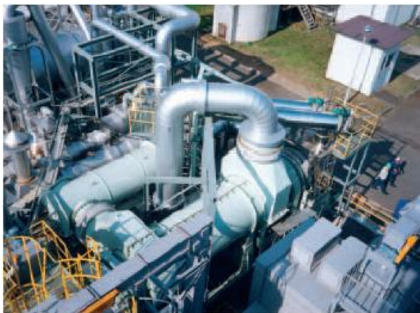
Unité de pyrolyse de déchets ménagers (1 t/h)
